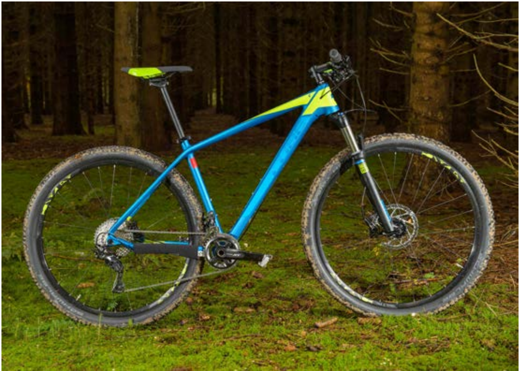
State-of-the-art carbonconstructie inclusief schijfremnokken en uitvaleinden.
