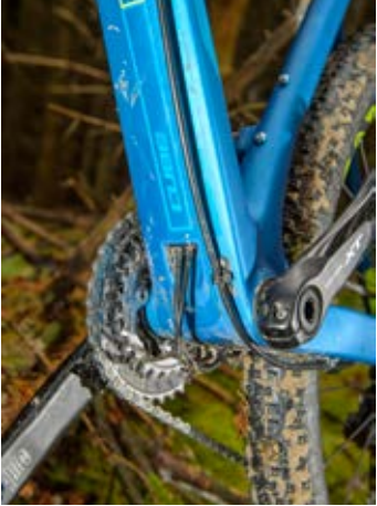
Superstijf en breed bracket met kabel-tunnel voor de derailleurkabels.
