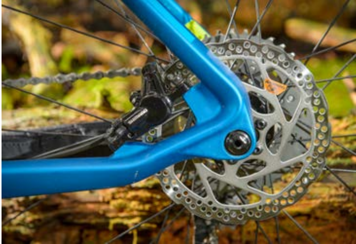
State-of-the-art carbonconstructie inclusief schijfremnokken en uitvaleinden.
