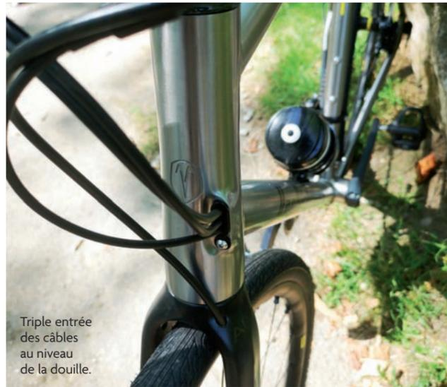
Triple entrée des câbles au niveau de la douille.
