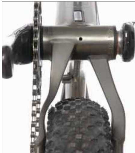
De ruimte tussen de band en het frame is meer dan gelimiteerd ondanks de bewerkingen van het titanium en de asymmetrie van de liggende achtervork.
