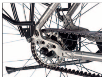
Präzise sind die Langlöcher zur Achsver-schiebung ins Edelmetall gefräst. An der Sitzstrebe sieht man das Riemenschloss.
